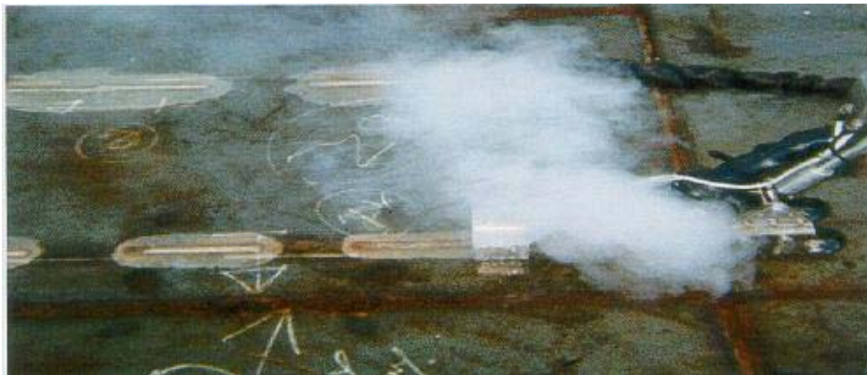
Fig. 6.10 Nærbillede af varnehoved med 160 mm varmelængde. Varmestregen er kun få mm bred [41].
