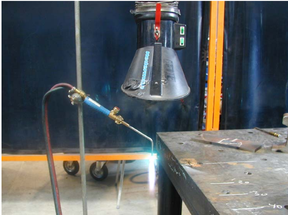
Fig. 9.1 Måleopstilling ved orienterende undersøgelse af forureningszonen ved gasbrændere og indfangningsgrad for lavtryksudsugning
