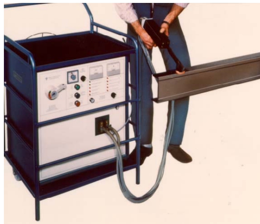
Fig. 6.12 Lokal opvarmning af flange med special induktionsspole [42].
