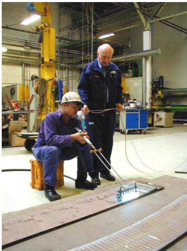
Fig. 3.4 Måling af operatøreksposering under flammeretning
