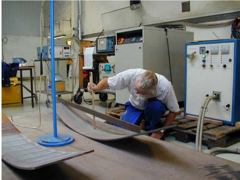
Figur 2.7 Måling af pilhøjde med retskinne og tommestok.
