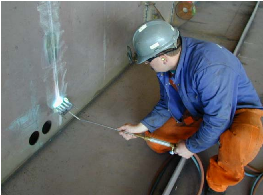
Fig. 5.2 Flammeretning af vinkelknæk på skot med rivebrænder med 3 dyser.
