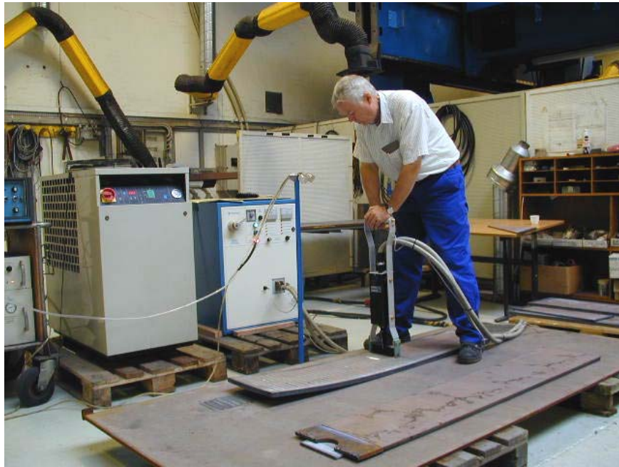
Fig. 3.3 Induktionsopvarmning 20 mm plade (forsøg 9)
