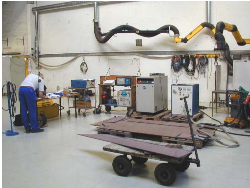
Fig. 3.1 Forsøgsopstilling med induktionsudstyr, gasmåleudstyr og pladeoplæg
