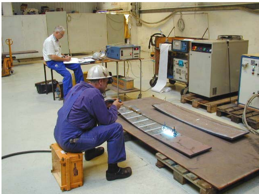
Fig. 3.2 Flammeretning 20 mm plade (forsøg 10)
