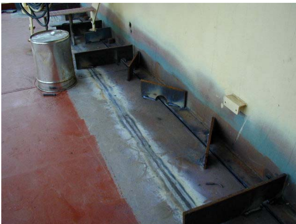
Fig. 5.4 Sektionsstød i dækshus efter flammeretning
