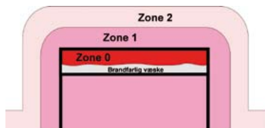
Figuren viser hvordan et renskar med et flygtigt opløsningsmiddel (f.eks. fortynder) kan zoneklassificeres:
