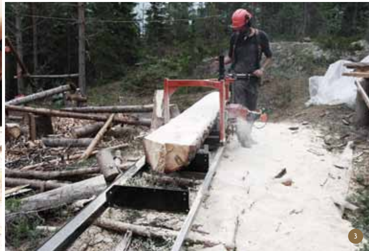
1 Søren Olsen brugte to år på at bygge sin træhytte i Sverige. 2 Med trisser og et spinkelt hejseværk kunne han løfte de tunge træstammer på plads. 3 Med et mobilt savværk foretog han al udskæring af træ på stedet.
