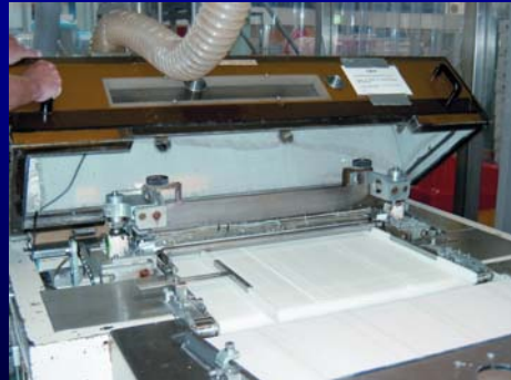
Indkapslingen lukket op, så man kan se den pneumatisk drevne kniv
