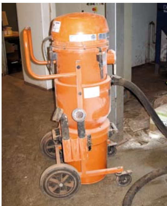
Store industri-stovsugere, der bruges til at fjerne fint brændbart støv, fx melstøv, kan danne eksplosiv atmosfære inde i støvsugeren.
