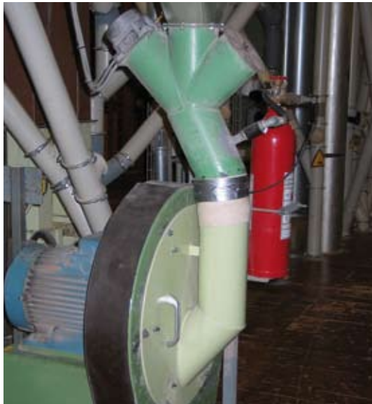
På slaglemollen til formaling af grove skaldele fra melproduktion er der monteret gnistdetektion og CO 2 -slukning, da der her er risiko for metalrester i materialet (og dermed gnistdannelse).
