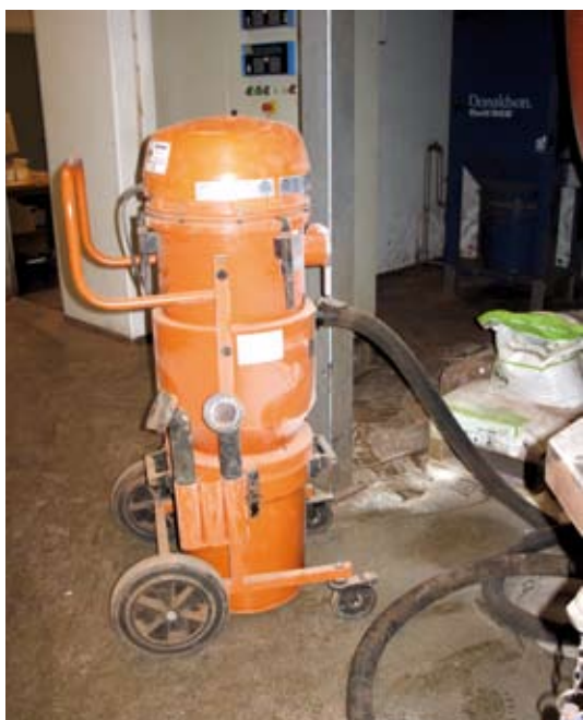
Store industri-støvsugere, der bruges til at fjerne fint brændbart støv, kan danne eksplosiv atmosfære inde i støvsugeren.
